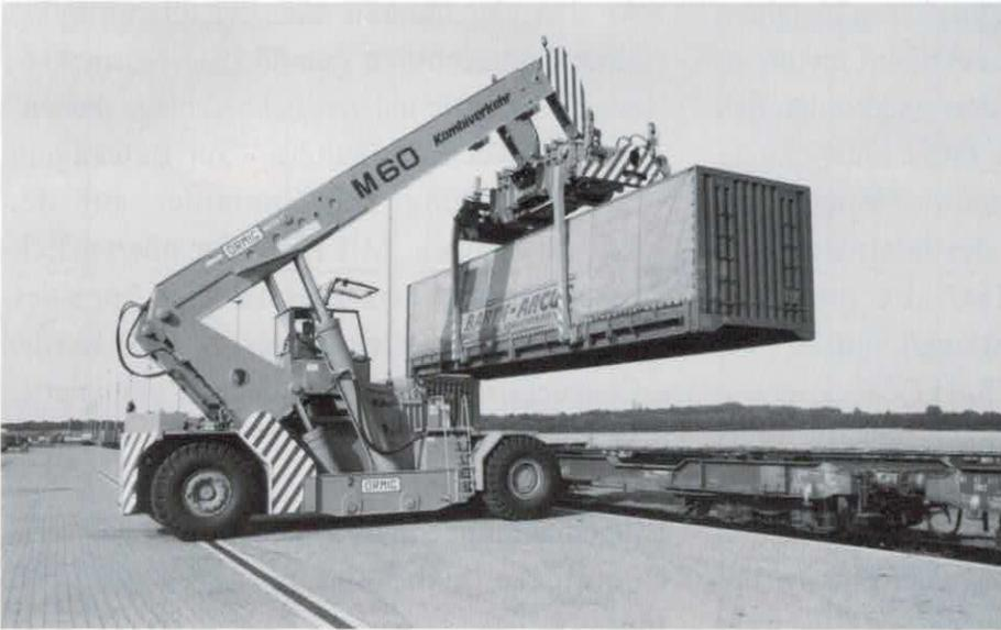
12 m Wechselbehälter der Klasse A - Verladen mit mobilem Umschlaggerät der *Kombiverkehr*
