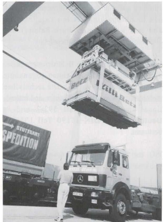
7,15 m Wechselbehälter der Klasse C - Kranumschlag mit Greifzangen
