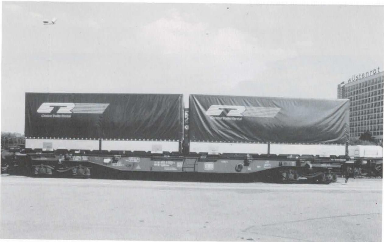
4achsiger Tragwagen zur Beförderung von Wechselbehältern und Containern
